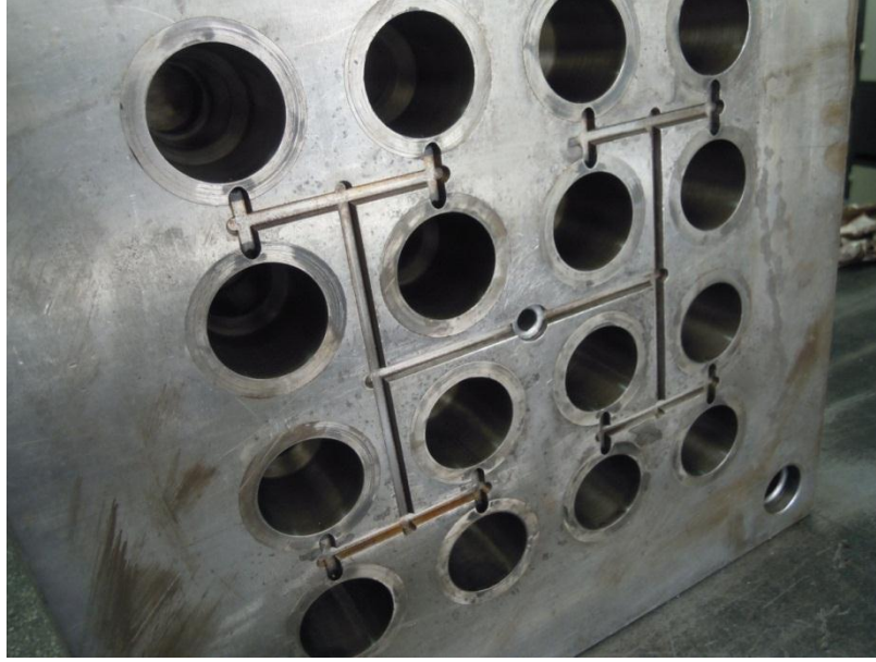
Şekil 9 16 Gözlü Bir Kalıpta Yolluk Sistemi
