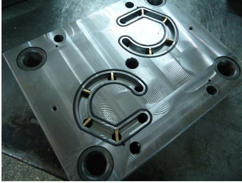
Resim 21 Diři Plaka Arka Kısmı, Delikler Etrafına Açılan Kanal
