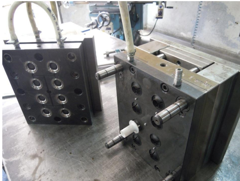
Şekil 3 Dişi Kalıp(solda) ve Erkek Kalıp(sağda)
