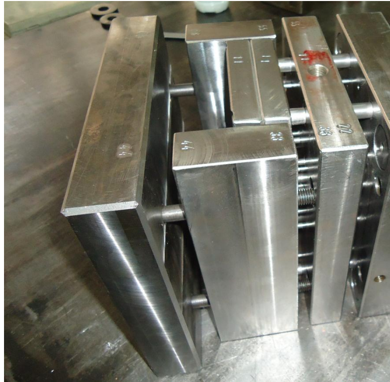
Resim 42 İtme Ayaklarının Montajı
