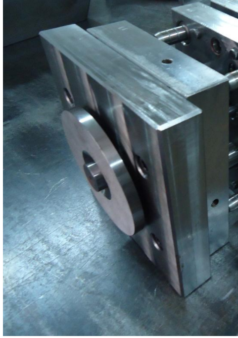
Resim 39 Diři Kısım Montajı
